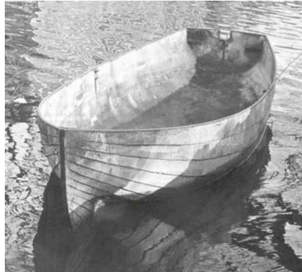
Roeiboot 'De Zeemeeuw' een duurzame beton- constructie uit 1887 en nog altijd intact te Sas van Gent
