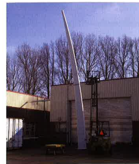
De composietpyloon voor de middenkolom staat bij de fabriek voor transport (foto: Royal HaskoningDHV)
