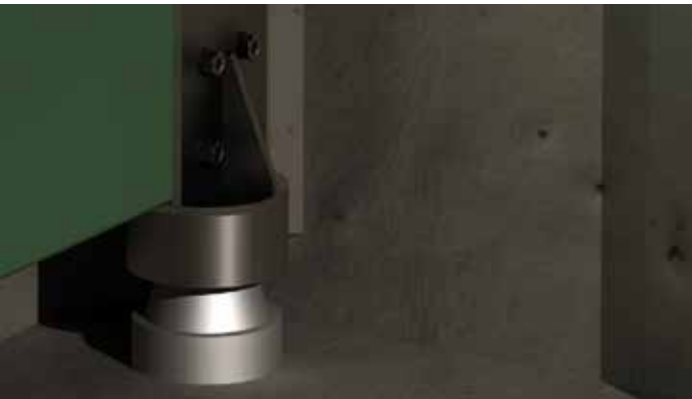
Verbindingen sluisdeur met boven- en onderscharnier.
