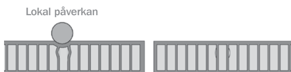
Med InfraCore® Inside kan inte lokala skador leda till brott med katastrofala följder. Dessutom utgör inte kärnmaterialet (skum) en del av den bärande konstruktionen, utan fungerar bara som plattshållare under tillverkningen.
